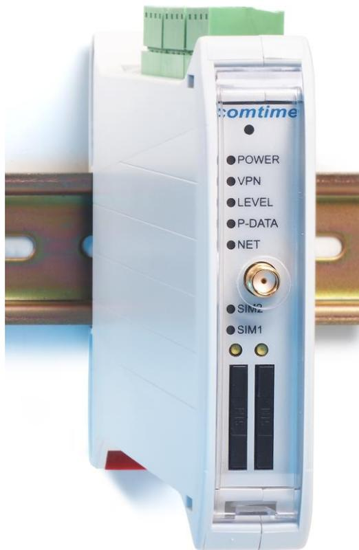
Der CT-Router UMTS ermöglicht einen einfachen Zugang zum Internet über das Mobilfunknetz. Zur Inbetriebnahme ist eine für die Paketdienste freigeschaltete SIM-Karte Ihres Mobilfunkbetreibers notwendig.
